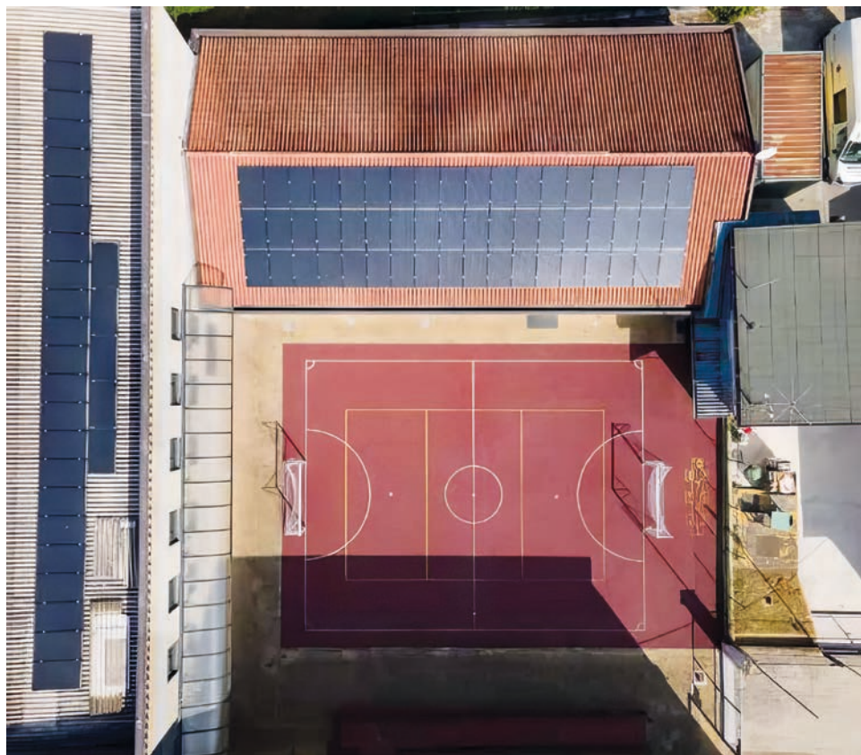
LA COMUNITÀ ENERGETICA DI TURANO LODIGIANO, REALIZZATA DA SORGENIA, PRODurrà CIRCA 50MILA KWH DI ENERGIA PULITA OGNI ANNO GRAZIE A DUE IMPIANTI FOTOVOLTAICI CHE HANNO UNA POTENZA COMPLESSIVA PARI A 45 KWP E SONO INSTALLATI SULLE AREE COPERTE DEL CAMPO SPORTIVO E DELLA PALESTRA LOCALI
